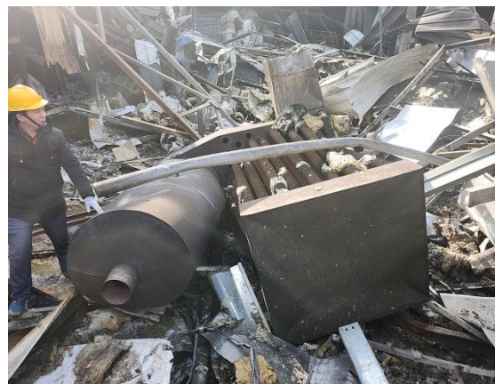
图 7 事发烘干系统燃烧桶及热交换器
