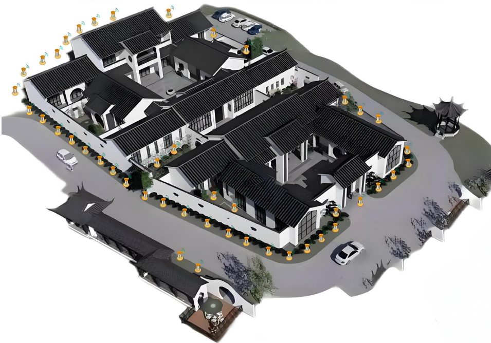
地下型白蚁自动化监测预警装置安装示意图
